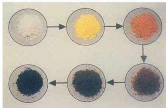
Abb. 1. Pulver von Q-Cd 3 P 2 -Teilchen. Die Teilchengröße nimmt in Richtung der Pfeile zu. Der Größenquantisierungseffekt ist besonders deutlich an der Farbe der Teilchen zu erkennen.
