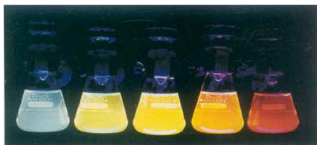
Abb. 12. Fluoreszenz von CdS-Kolloiden mit kleinen Bereichen von HgS. Die HgS-Bereiche werden in den Proben von links nach rechts größer.
